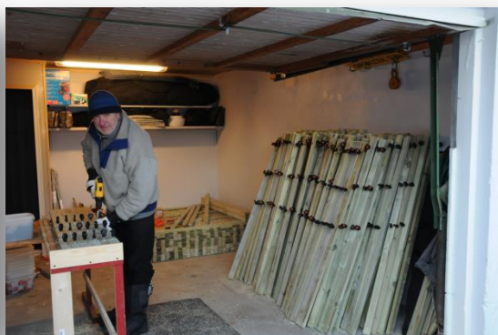
Planlegging: Mye skal drøftes når et el-gjerde skal realiseres. Fra venstre: Jon Andreas Ask, Ole-Petter Haugen, Magne Akervold, Einar Ottesen og Kolbjørn Berg. Ole-Petter monterer isolatorer på lekters. Under er el-gjerdet på plass, og elgen har tydeligvis respekt for strømmen.
